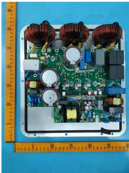
图 11 机体内部布局图-拆除上盖（样品型号：SOFAR 3300TL-G3 系列）
